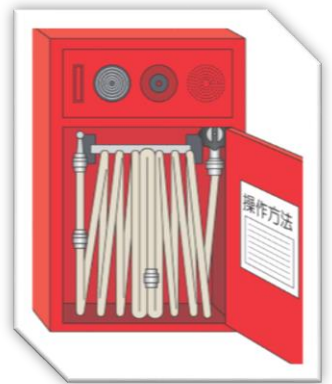
屋内消火栓設備
